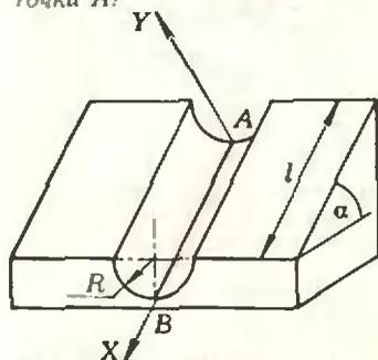
Разложим силу тяжести  $m\vec{g}$ , действующую на шарик, на две составляющие, одна из которых направлена вдоль оси желоба и равна  $mg \sin \alpha$ , а другая —  $mg \cos \alpha \equiv mg'$  — лежит в плоскости, перпендикулярной осн. Движение шарика вдоль оси будет равноускоренным с ускорением  $a = g \sin \alpha$ . В плоскости, перпендикулярной оси, шарик будет совершать малые гармонические колебания с периодом
